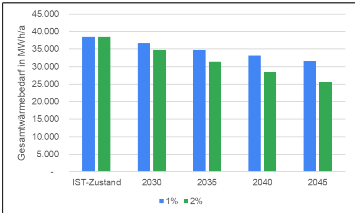
Abbildung 26: Sanierungsquote 1 % und 2 % bezogen auf den Gesamtwärmebedarf bis zum Jahr 2045
